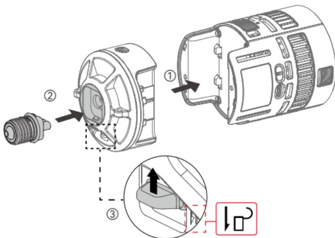
2. 如需拆卸，拨动推制“咔”一声表示已解锁，将 E27 转接件拔出即可。
