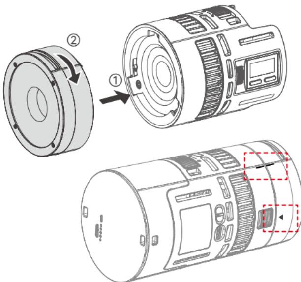
**拆卸：**按住卡口推制，逆时针旋转透镜反光杯即可拆卸完毕。
