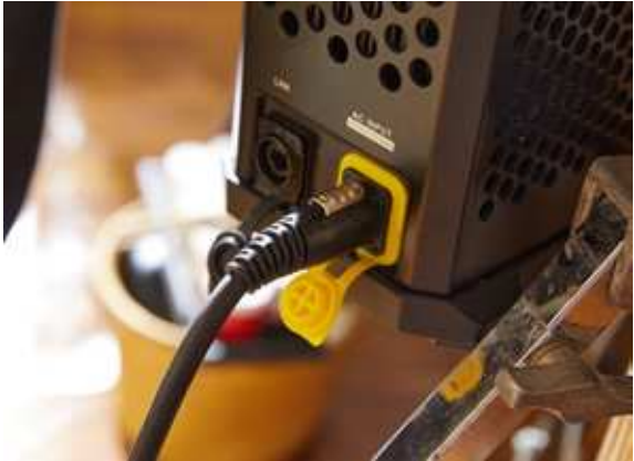
纽崔克插头，一键按压拔插，快捷可靠。
